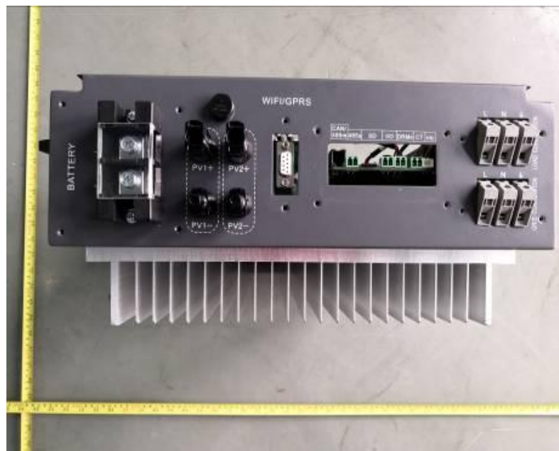
Figura 2, Vista do painel de terminais
